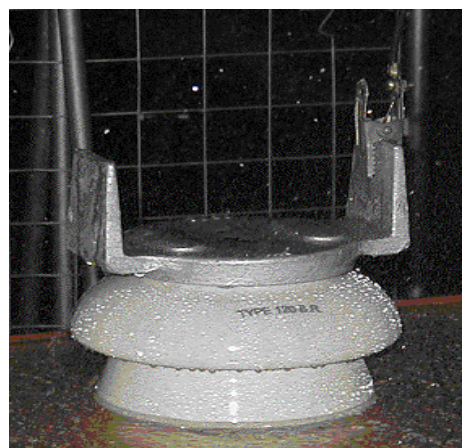
Рис. 1 – Изолятор, обработанный VoltShield
